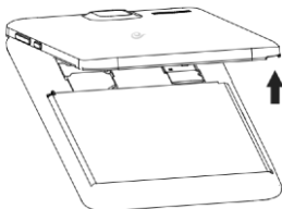
图 1 拆卸手机后盖
